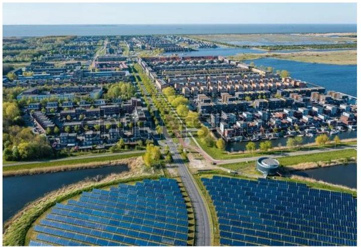
Barrio moderno sostenible en Almere, Holanda La calefacción de la ciudad (stadswarmte) en el distrito está parcialmente alimentada por una isla de paneles solares (Zoneiland) .
