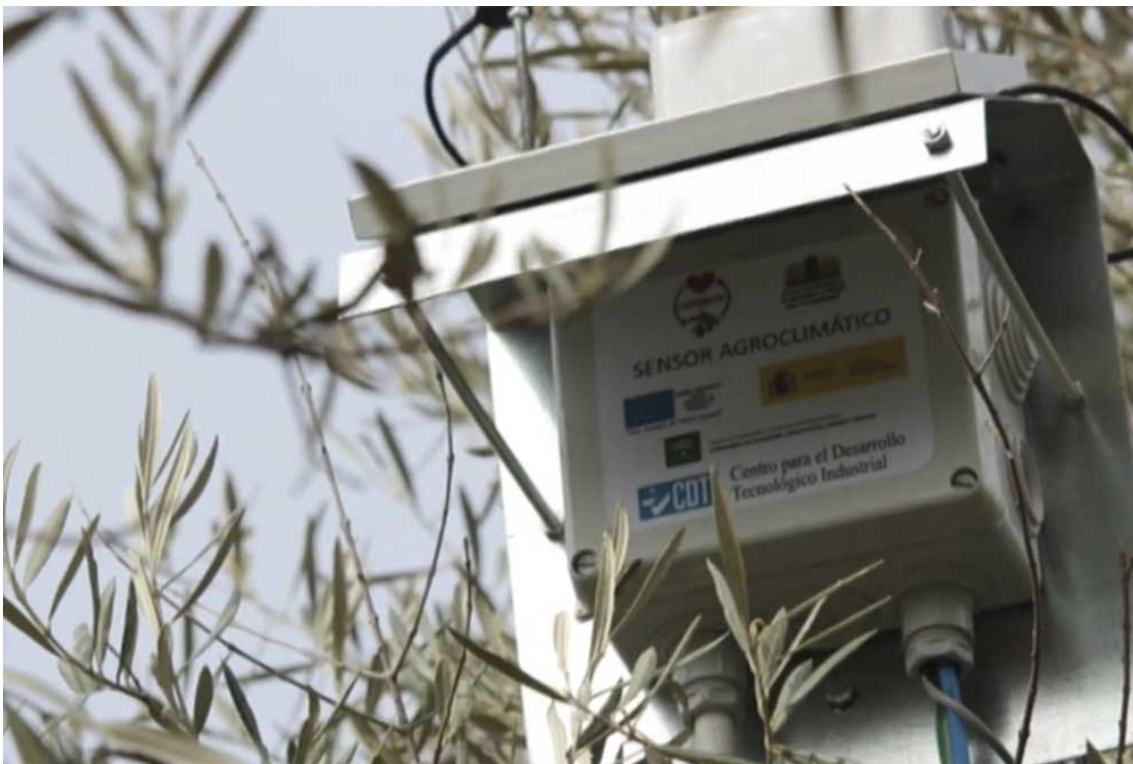
FOTO 18. SENSOR INSTALADO EN UN OLIVO PARA CONTROLAR LA EVOLUCIÓN DEL FRUTO
